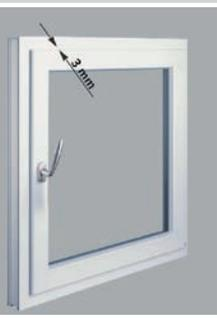
◀ Eine **Mikroventilation** ist durch Drehen des Griffs möglich. Man muss bis etwa 45 Grad aus der horizontalen Position den Griff drehen. Zwischen dem Rahmen und der Flügel entsteht dann eine Lücke, die eine konstante Frischluftzufuhr gewährleistet. Der Flügel bleibt in dieser Stellung aufgrund durch einer speziellen Dichtverriegelung.
